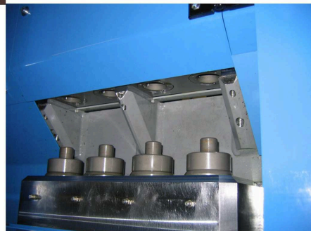
pneumatische 4-fach-Spannvorrichtung mit gehärteten Wechselbacken
